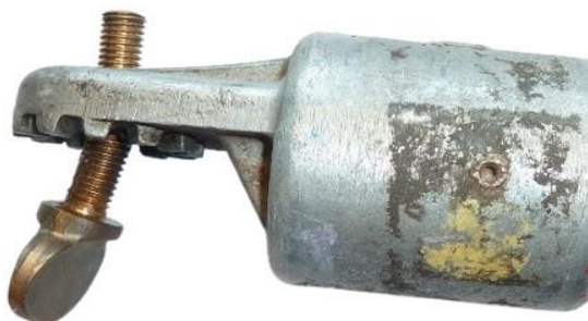
Déformation ne permettant plus d'assurer la fluidité, le réglage ou la position de blocage du mécanisme.
