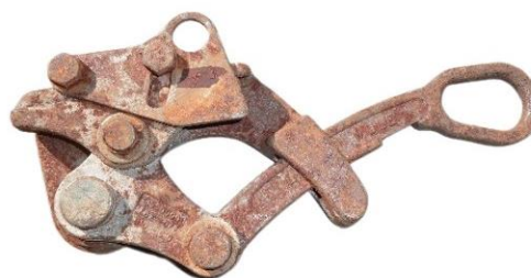
Corrosion active venant modifier la fluidité ou les positions de blocage des mécanismes
