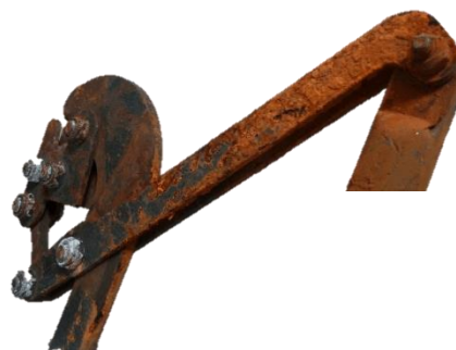
Corrosion active avec effritement venant gêner la fluidité, le réglage ou les positions de blocage de l'outil
