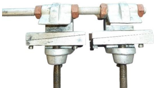
Corrosion non active sans perte de matière ne gênant pas la fluidité, le réglage ou le blocage des mécanismes
