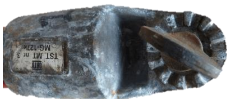
Corrosion non active sans perte de matière ne gênant pas la fluidité, le réglage ou le blocage des mécanismes
