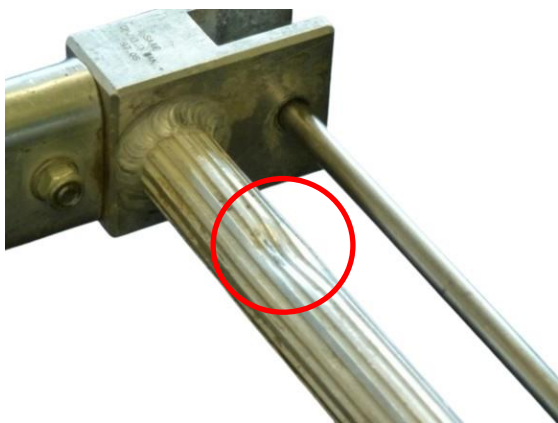
Choc ne remettant pas en cause la résistance mécanique de l'outil ni la fluidité, le réglage ou la position de blocage du mécanisme
